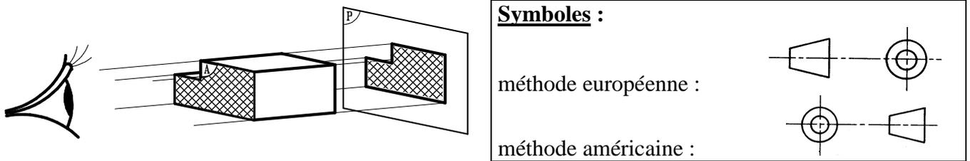
Le plan de représentation est **parallèle** à la face observée de l'objet et donc **perpendiculaire** aux rayons visuels (d'où le nom de **projection « orthogonale »**).
