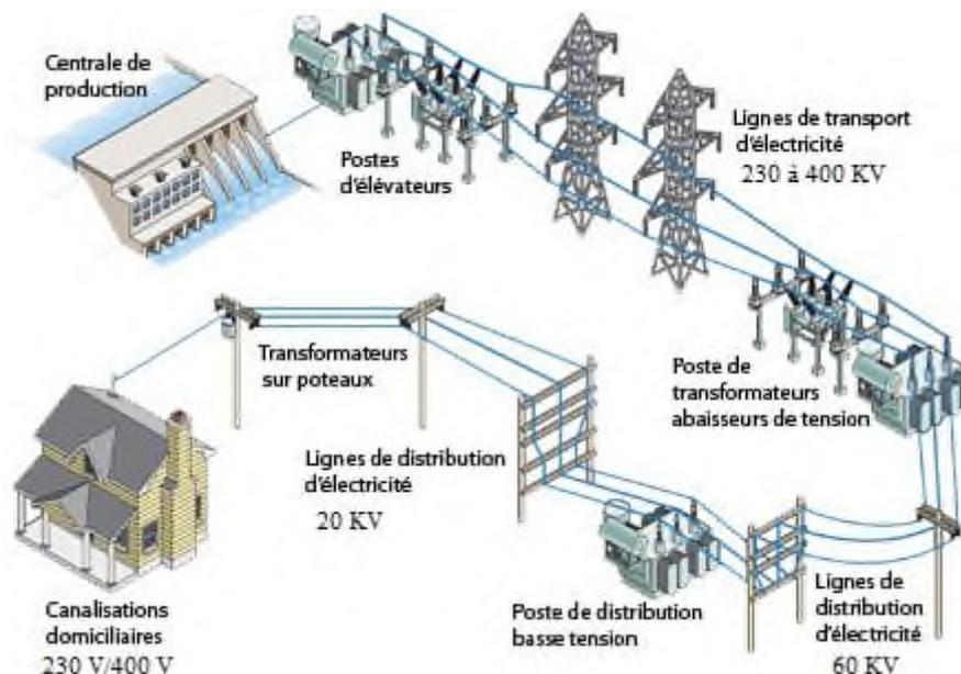
On appelle réseau électrique l'ensemble des infrastructures permettant d'..... l'énergie électrique des centrales de production, vers les consommateurs d'électricité.
