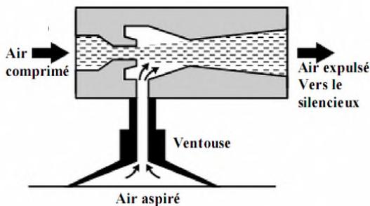
L'air comprimé, en passant rapidement dans le venturi, provoque à cet endroit une dépression et entraîne avec lui l'air présent dans le conduit perpendiculaire. D'où l'aspiration disponible au niveau de la ventouse.
