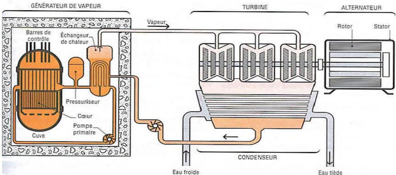
À l'intérieur du réacteur, ..... est le siège d'une réaction nucléaire qui produit une grande quantité de ..... Cette chaleur est continuellement évacuée hors du réacteur vers un échangeur de chaleur grâce à un fluide dit caloporteur.
