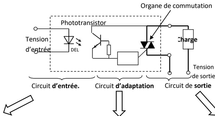
Celui-ci assure **l'isolement** galvanique entre le circuit de commande et celui de puissance. Cet isolement est assuré par un photocoupleur.
