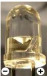
Le passage du courant de l'Anode (+) à la cathode (-) crée la luminescence (émission par la matière d'un rayonnement lumineux visible)
