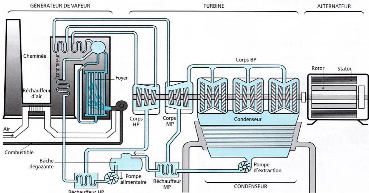
Une centrale thermique à flamme produit de l'électricité en ..... **un combustible** (charbon, gaz ou fioul) dans une chaudière qui **produit de** ..... Cette **vapeur** actionne **une** ..... qui entraîne un .....
