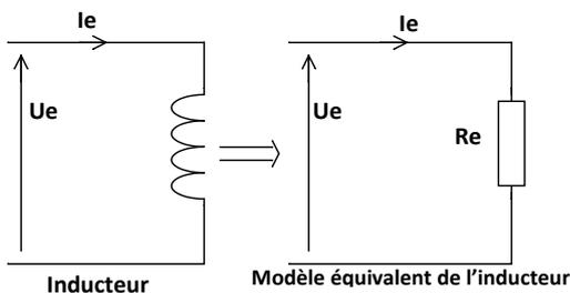
Lorsque l'inducteur n'est pas à aimants permanents, il est constitué de bobines en série traversées par un courant continu **Ie**, appelé **courant d'excitation**.
