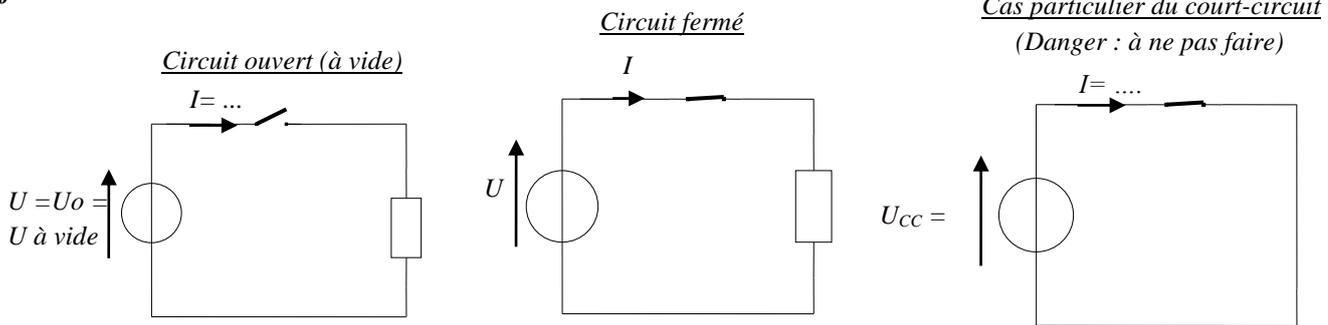
Par convention, on dit que le courant sort de la borne (+) du générateur ; il est opposé au sens réel du déplacement des **électrons**.
