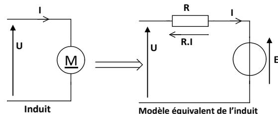
L'induit, soumis à une tension **U** dite tension d'induit, est constitué de conducteurs, de résistance **R**, traversés par un courant continu **I** dit courant d'induit. Il génère une f.é.m. ou une f.c.é.m. **E** suivant qu'il fonctionne en génératrice ou en moteur.
