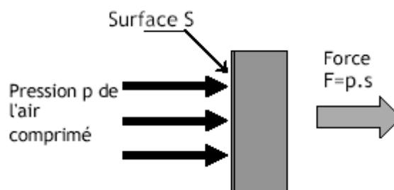
En faisant agir l'air comprimé sur une face immobile, on obtient **une force F** proportionnelle à la pression **p** et à sa surface d'action **S** :
