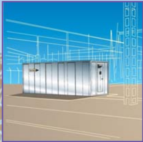
Bâtiment de relaying Chaque ligne est surveillée par des équipements électroniques regroupés dans un bâtiment
