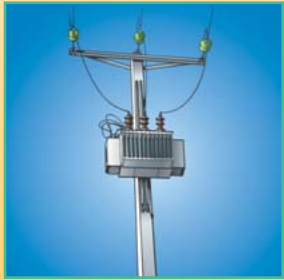
Transformateur moyenne tension/basse tension
