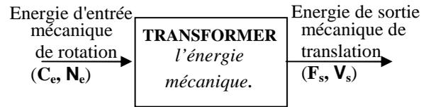
Dans ce mécanisme, la rotation du pignon entraîne le déplacement de la crémaillère (et inversement) :
