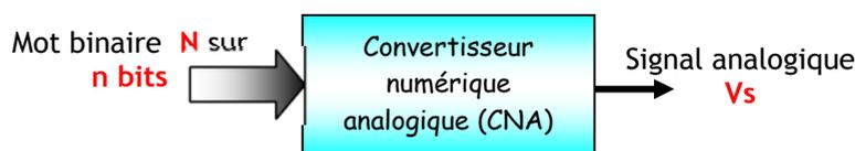
Les CNA permettent à **Unité de traitement** de commander des dispositifs analogiques.
