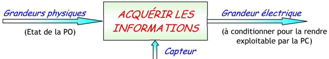
*Le conditionneur d'un capteur* a pour rôle principale de produire une tension image de la grandeur physique mesurée à partir de la grandeur électrique de sortie du capteur.
