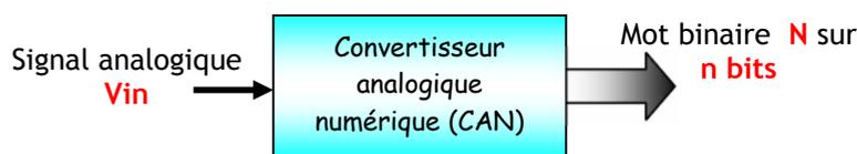
Les CAN permettent à **Unité de traitement** de traiter des signaux analogiques.
