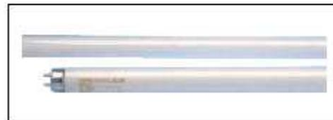
Le tube fluorescent contient de l'argon qui s'ionise très rapidement, s'échauffe instantanément et provoque la vaporisation de mercure. Le revêtement interne du tube est un mélange de sels minéraux fluorescents, sous forme de cristaux de quelques microns. La température de couleur de la lumière émise dépend de la composition de la poudre fluorescente
