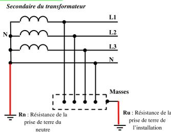
La coupure de l'installation est obligatoire dès l'apparition du défaut. La protection est assurée par un **dispositif différentiel** :
