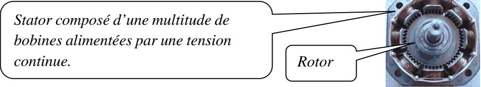
On rencontre les moteurs pas à pas unipolaire et bipolaire qui se différencient par la structure de leur stator et leur commande.
