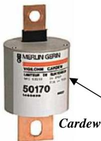
Il permet d'écouler à la terre les surtensions dangereuses susceptibles d'apparaître comme un défaut à la terre dans le poste de transformation ou un amorçage entre enroulements HT et BT d'un transformateur.
