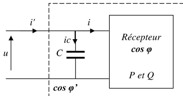
L'objectif est de dimensionner le condensateur en fonction du facteur de puissance recherché  $\cos \varphi'$
