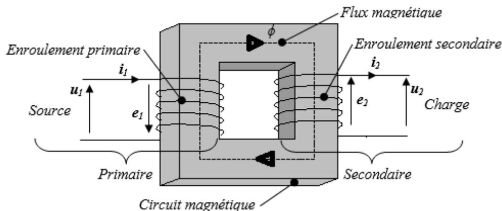
Il est constitué de 2 enroulements placés sur un circuit magnétique fermé :
