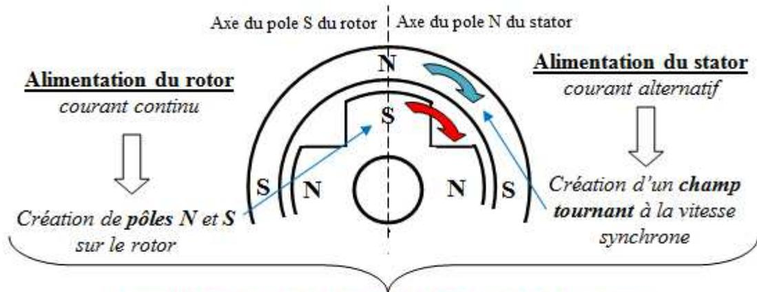
*Les pôles S du rotor sont entraînés par les pôles N du stator.
