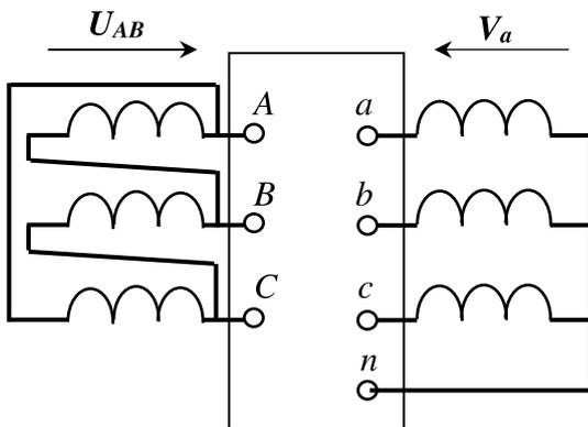
Les tensions aux bornes des enroulements primaire et secondaire d'une colonne sont en phase.
