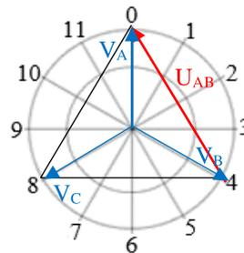
On pose le vecteur tension  $V_a$  parallèle au vecteur  $U_{AB}$  car les tensions  $V_a$  et  $U_{AB}$  sont en phase (même colonne).
