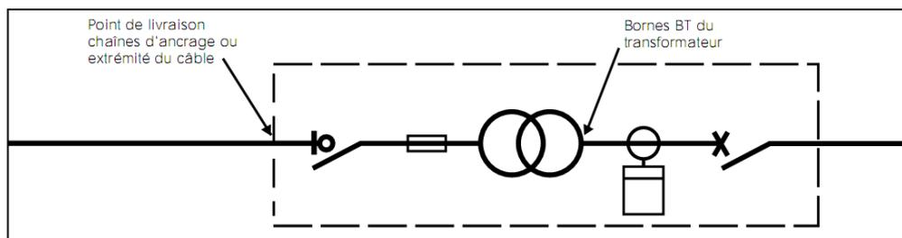
Le comptage en basse tension nécessite un **transformateur de courant**, la tension est mesurée directement : comptage **peu coûteux**.
