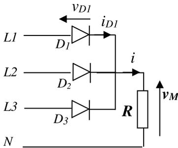
$v_M = v_1, v_2$  ou  $v_3$  la plus positive à l'instant considéré :
