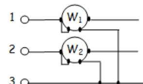
Le montage des deux wattmètres est utilisé que le système soit équilibré ou non. (La seule condition est qu'il n'y ait pas de fil neutre).
