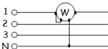
Il suffit de mesurer la puissance consommée par une phase et de multiplier par trois. Un seul Wattmètre est nécessaire :  $P = 3 P_{IN}$
