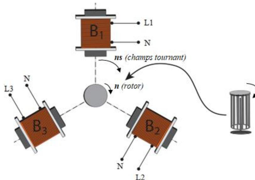
Les 3 bobines (enroulements) statoriques ( $B_1$ ,  $B_2$  et  $B_3$ ) de  $p$  paires de pôles, alimentées par un système de tensions triphasées de fréquence  $f$ , créent un **champ magnétique tournant** à la vitesse  $ns = f/p$  nommée **vitesse de synchronisme**.
