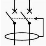
La sensibilité  $I_{\Delta N}$  de ce DDR dépend de la tension limite de sécurité  $U_L$  et de la résistance de
