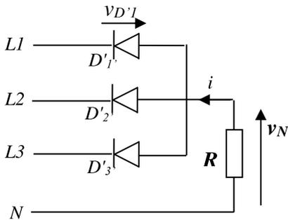
$v_N = v_1, v_2$  ou  $v_3$  la plus négative à l'instant considéré :
