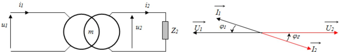
L'intensité du courant  $I_2$  dépend de la charge appliquée au secondaire, il en est de même pour le facteur de puissance  $\cos \varphi_2$ . Ces deux grandeurs imposent l'intensité du courant  $I_1$  appelé au primaire, ainsi que le facteur de puissance du primaire, sachant que  $\varphi_1 = \varphi_2$ .
