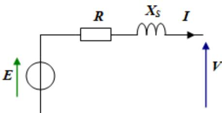
Equations :  $\underline{E} = R.\underline{I} + j X_s.\underline{I} + \underline{V}$  soit  $\underline{V} = \underline{E} - R.\underline{I} - j X_s.\underline{I}$
