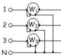
Il faut mesurer les puissances consommées par les trois phases et les additionner. Trois wattmètres sont nécessaires :
