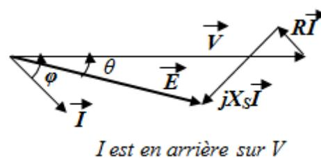
**Equations** :  $\underline{E} = \underline{V} - R \cdot \underline{I} - j X_s \cdot \underline{I}$  soit  $\underline{V} = \underline{E} + R \cdot \underline{I} + j X_s \cdot \underline{I}$ .
