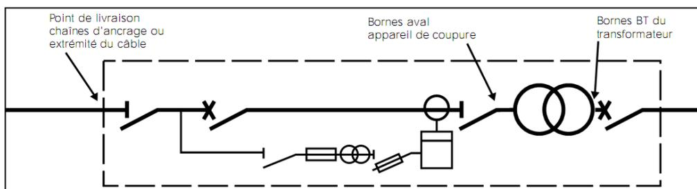
Le comptage en haute tension nécessite un **transformateur de courant** et un **transformateur de tension** (adapter les grandeurs) : **comptage coûteux**.
