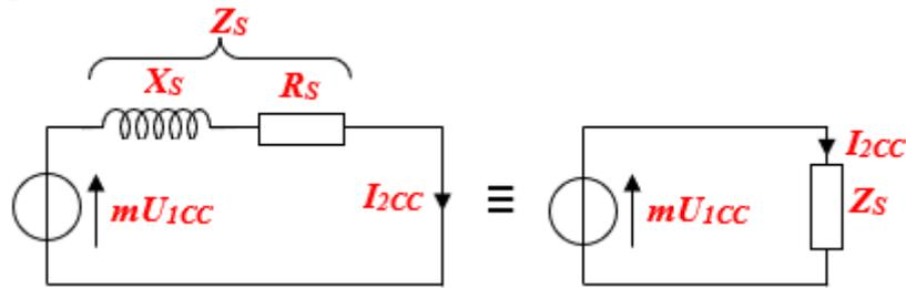
Toute la puissance  $P_{1CC}$  consommée lors de cet essai est dissipée dans la résistance  $R_s$  (puissance active) :
